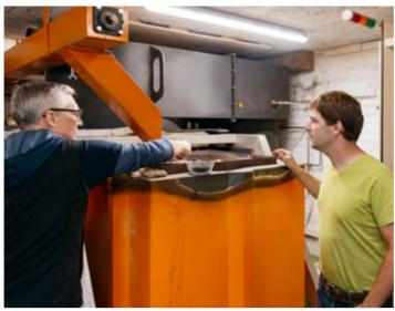
Die Pflanzenkohle gewinnt Michael Kipfer aus Holzschnitzeln aus dem eigenen Wald. Das Holz wird in die Pyrolyse-Anlage gefüllt und angezündet. Die entstandene Pflanzenkohle wird anschliessend in einer alten Haferquetsche gemahlen.
